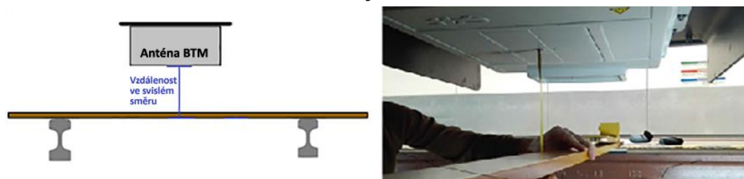
Obrázek 59. Požadavek na vzdálenost ve svislém směru
