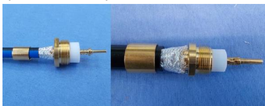
Obrázek 76. Středový kontakt RG-58 a RG-213
