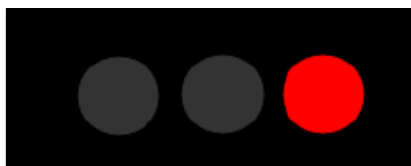
Obrázek 11. Červená LED: Chyba DMI. Není funkční (chybový režim)
