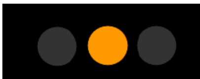
Obrázek 7. Svítí oranžová LED: aplikace DMI se spouští (normální režim)
