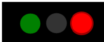
Obrázek 10. Zelená LED svítí a červená bliká: DMI je v provozu a dosáhlo své vypínací teploty (normální režim)
