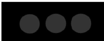
Obrázek 13. Žádná LED nesvítí: Spuštění DMI po údržbě (režim prvního spuštění)
