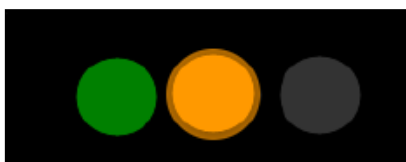
Obrázek 9. Svítí zelená LED a bliká oranžová: DMI je v provozu a dosáhlo výstrahy na nadměrnou teplotu (normální režim)
