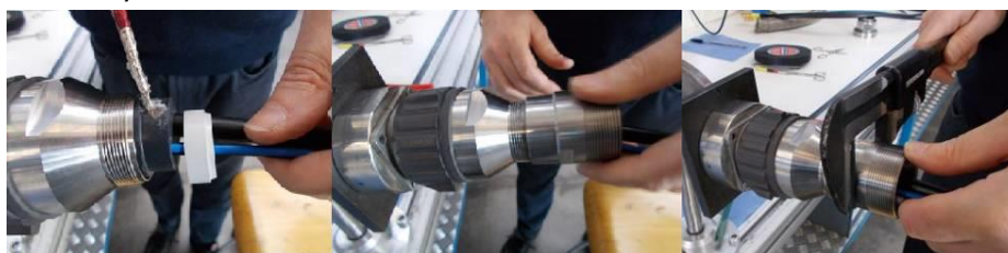
Obrázek 81. Zadní plášť konektoru BTM
