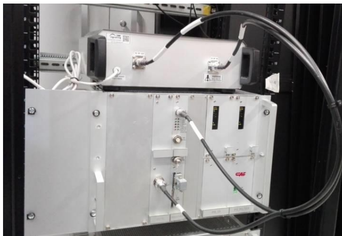
Obrázek 54. Skříň údržby BTM připojená k panelu BTM pomocí Kabelového panelu údržby BTM
