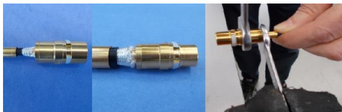
Obrázek 77. Montáž RG-58 a RG-213
