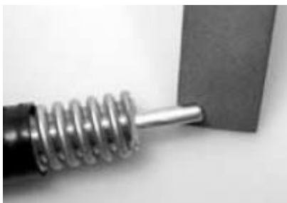
Obrázek 98. Vnitřní odjehlení
