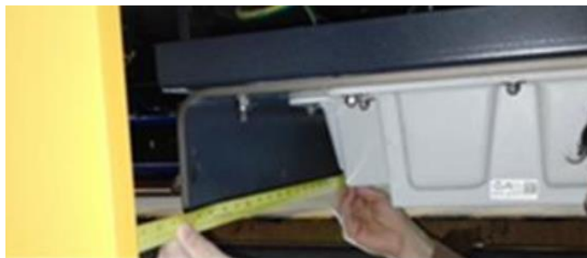
Obrázek 62. Maximální odchylka v ose Z (d2)
