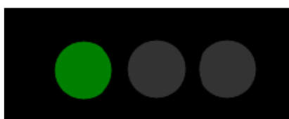
Obrázek 8. Svítí zelená LED: DMI se spustilo a je v provozu (normální režim)
